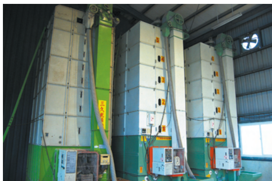
▲稻穀以循環式乾燥機採三段式變溫烘乾較佳。
