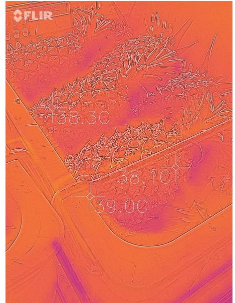
圖7. 使用熱影像儀針對整批果實概略測量表面溫度
