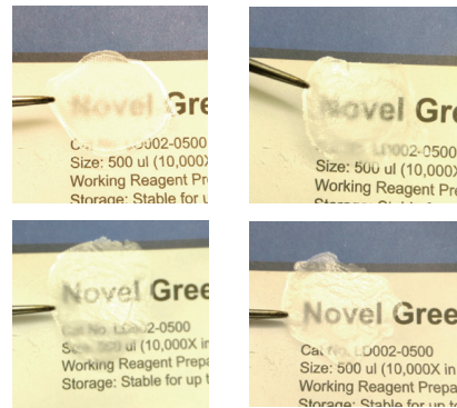
圖二、透過特殊萃取製程可提升絲質蛋白之透明度及穩定性 ( 左上：傳統製程；右上、左下及右下：創新製程 )
