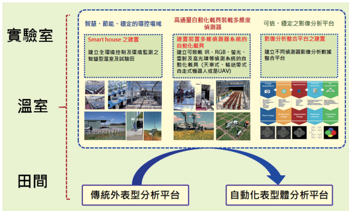
圖二、自動化植物表型體分析平台。
