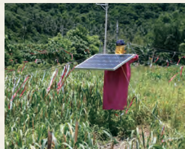
圖 4 | 太陽能人型驅鳥器田間運作情形
