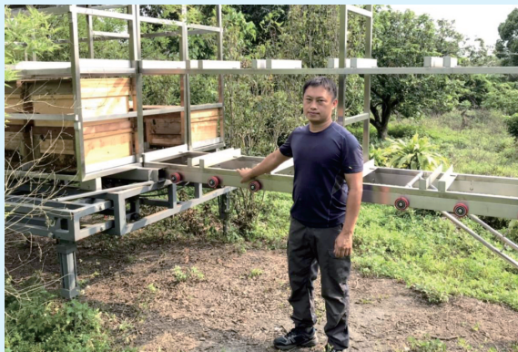
「可卸式貨車載物座」上裝載蜂箱承架，可直接於蜂場卸載承架後放養蜂群，無需人工挑運蜂箱
