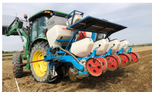
圖四、四行式真空播種機進行機械播種
