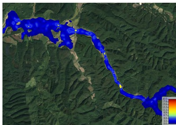
圖 14 (a) Case6 潰壩最快流速分布圖 (b) Case8 潰壩最快流速分布圖
