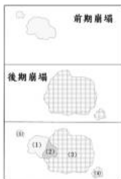
圖 3、崩塌地變遷及分類示意(改編自陳俞旭，2008)。
