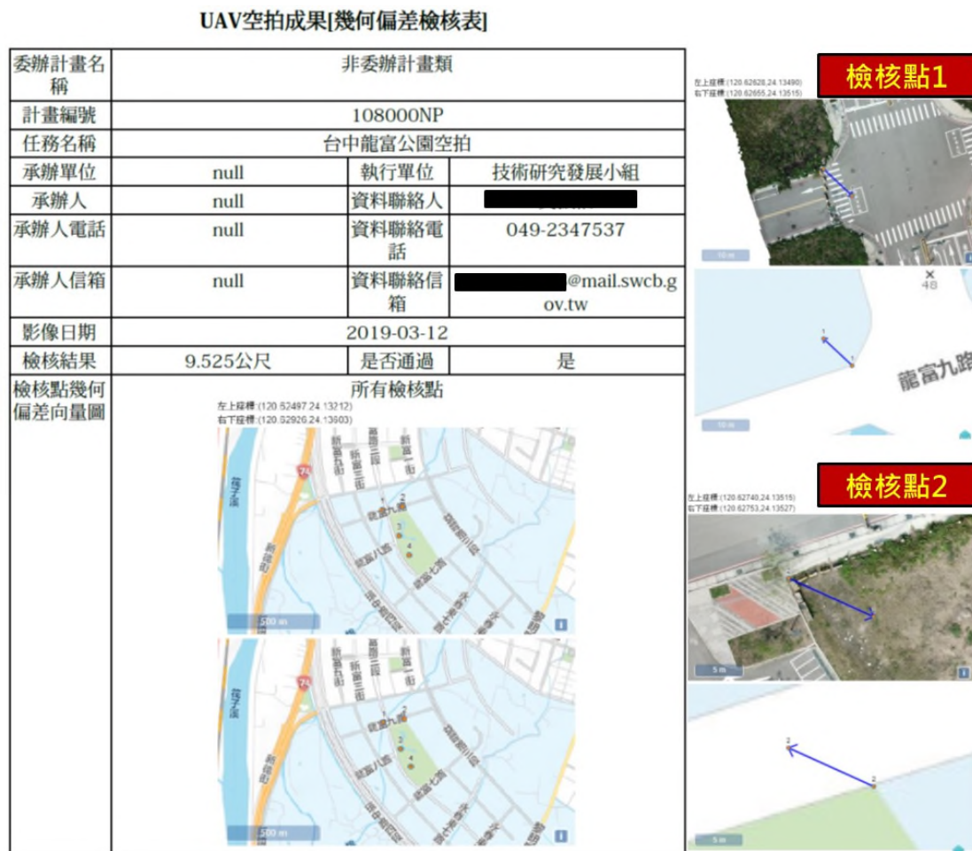
圖 3-12 UAV 空拍成果-幾何偏差檢核表
