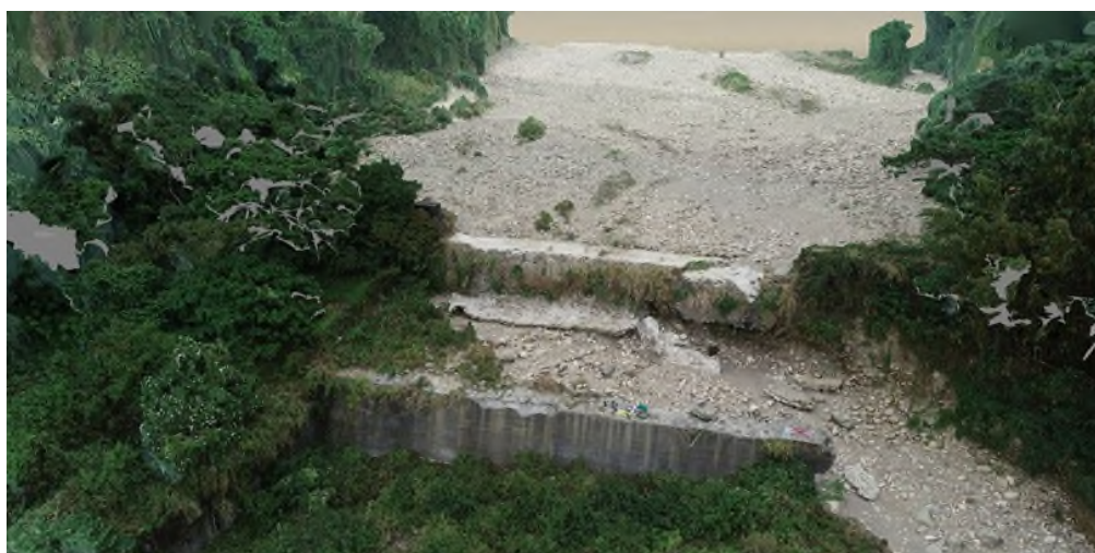
圖 4-35 三支水第一號防砂壩 3D 建模成果 (2)
