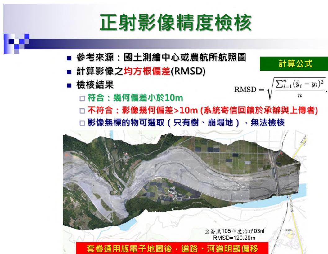
圖 3-11 正射影像精度檢核
