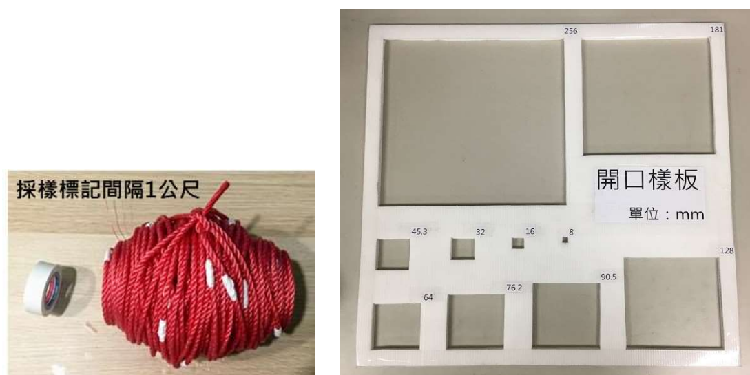
圖 3-3 開口樣板及採樣繩 (水保局，2019，無人載具高解析影像及光達點雲於山區河川表層粒徑分析之精進研究)
