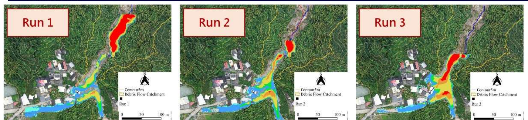
圖1. 土石流溢流點位置變化對土石流堆積範圍之影響(Run1) 108年土石流溢流點, (Run2) 109年土石流溢流點, (Run3) HOST地圖判釋溢流點
