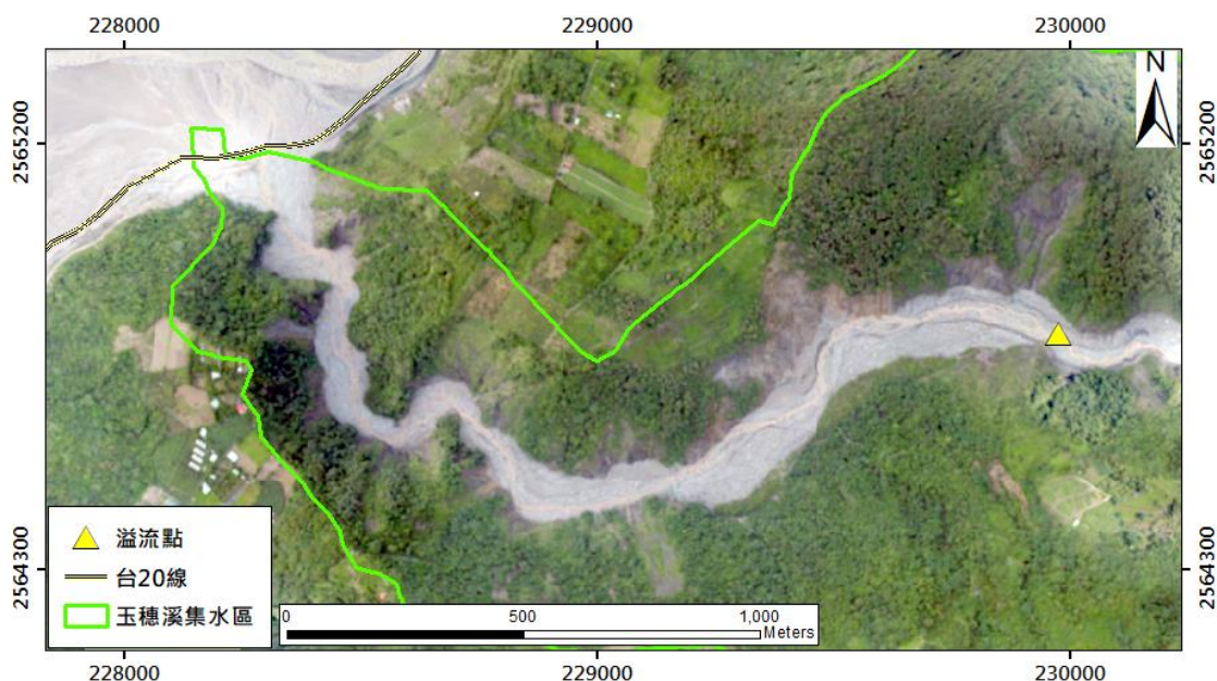
圖 4-36 UAV 空拍產製正射影像所判釋溢流點位置
