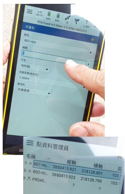
圖 4-4 左：TDC600 操作介面，右：靜態測量解算之觀測 O 檔
