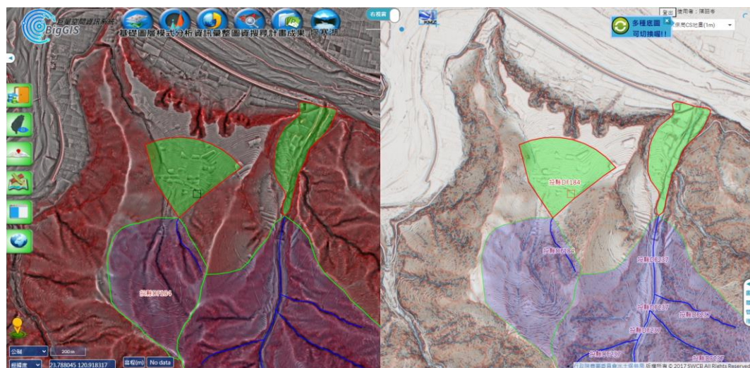
圖 2- 15 坡面型土石流。左圖為 H.O.S.T 地圖判釋成果；右圖為 CS 地圖判釋成果
