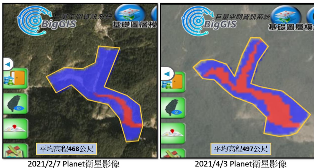
圖 4-26 BigGIS 挖填方分析工具估算堰塞湖迴水面積及蓄水量(紅色填方；藍色挖方)
