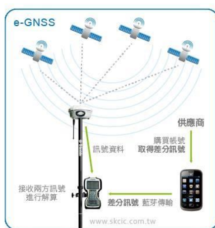
圖 4-3 差分定位示意圖 (摘自久冠測量儀器有限公司)
