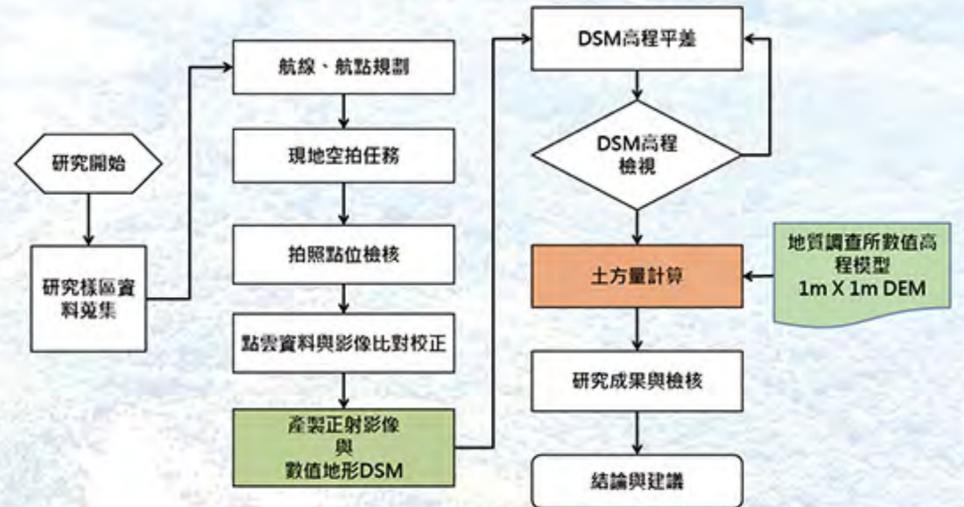
研究流程為於2017年3月23日利用無人飛行載具 (Unmanned Aerial Vehicle, UAV) 重建災後三維地形數值模型 (圖1)，利用災後空拍所產製之正射影像，圈繪紅葉區北絲蘭溪上游崩塌發生區域之範圍 (圖2)，並以此為依據進行崩塌區域前、後地表高程差的比較，兩者之差異值即為該區域之崩塌量。
