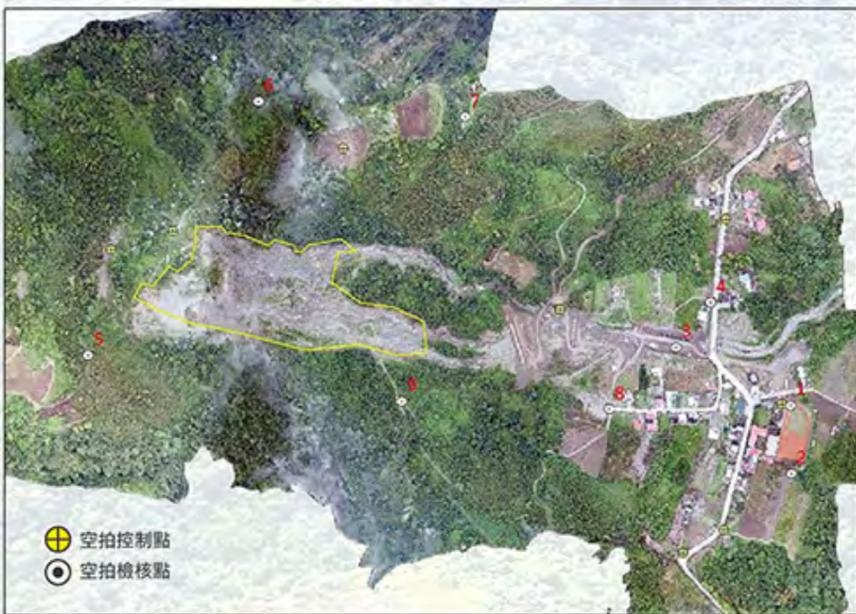
▲ 圖2、災後崩塌正射影像與崩塌範圍
