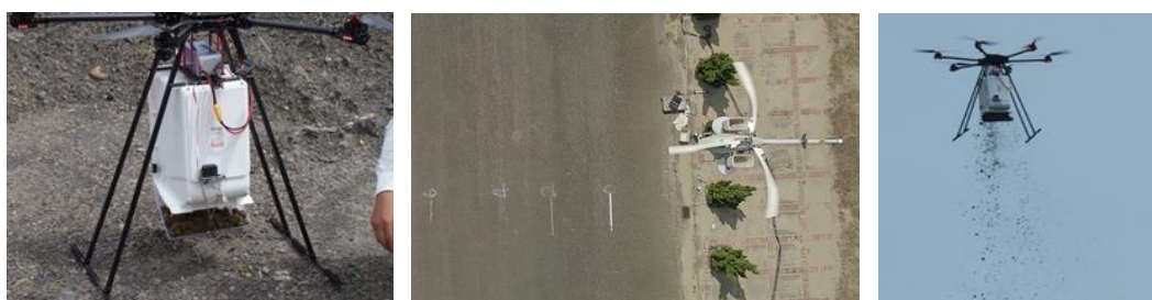
圖十 單旋翼與六軸 UAV 投擲設備
