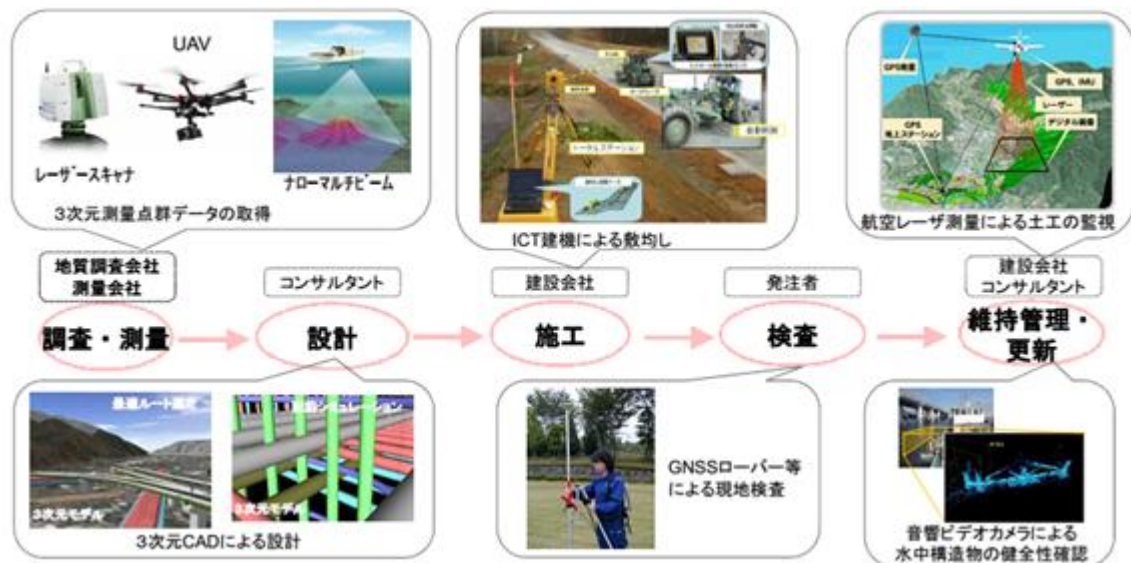
圖 3.1.10 i-construction 現場工程導入新技術示意圖
