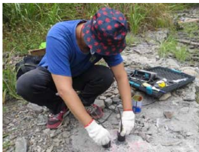
圖 2 應力波速量測試驗
