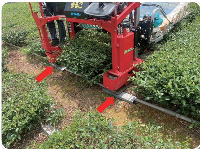
圖三、灌溉水管上方放置 C 型鋼可避免灌溉管路毀損。
