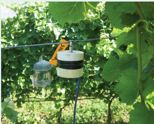
圖三、義大利團隊利用振動器播放干擾訊號並藉由連接電纜來傳遞給葡萄園中的葡萄植株，用於干擾葡萄帶葉蟬的交配 (圖引用自 <https://doi.org/10.1002/ps.3848>)。
