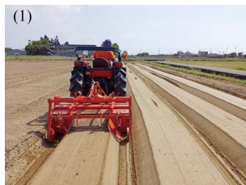
圖十一、超碎土成型式迴轉犁築畦器一次單畦(1)及所作畦面(2)
