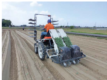
圖四、全自動雙行式移植機
