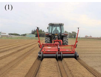
圖十、滾輪式迴轉犁築畦器可一次作雙畦(1)及所作畦面(2)
