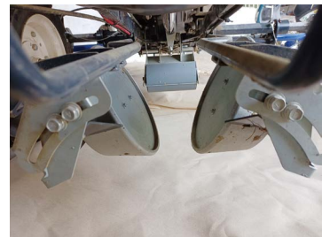
圖七、移植機之覆土滾輪
