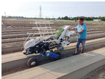
圖三、全自動單行式移植機
