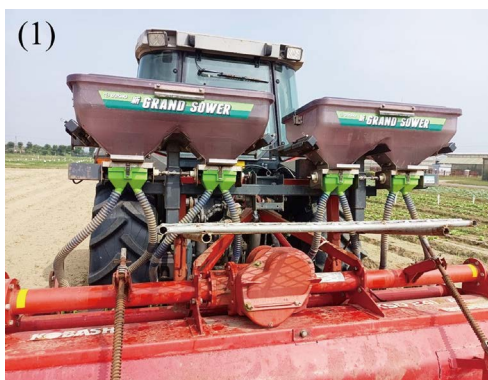
圖一、曳引機附掛施肥桶進行作畦同步施肥(1)、(2)
