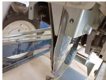
圖六、移植機之移植鉢(鴨嘴種植杯)
