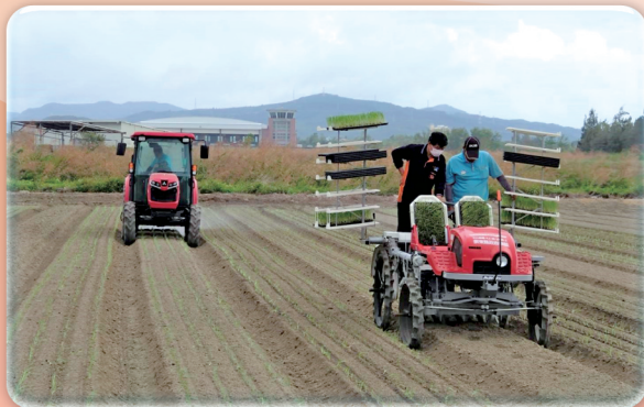
乘坐式洋蔥移植機種植作業情形
