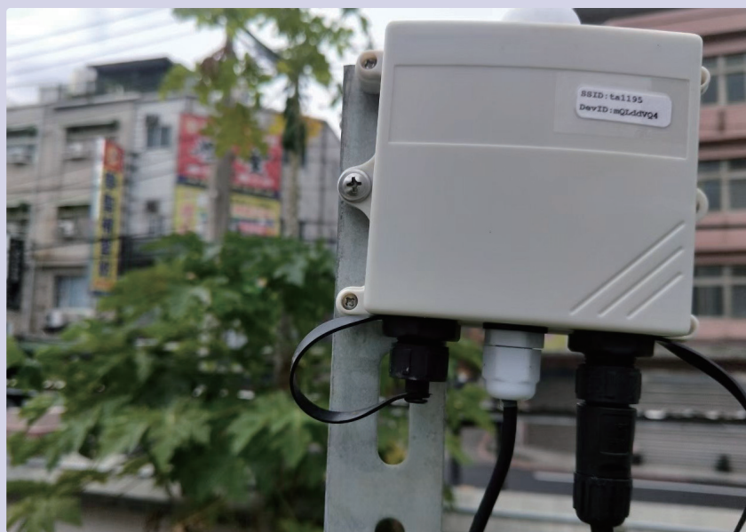
▲澆水管理模組中的環境感測器，具有偵測光度、土壤濕度及空氣溫濕度的功能。
