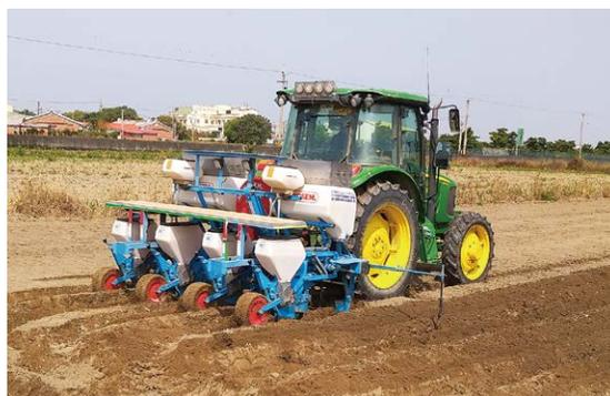
圖一、真空播種機進行播種、施基肥的作業
