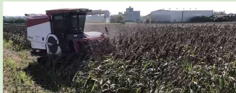
▲圖3、以水稻聯合收穫機進行機械採收。
