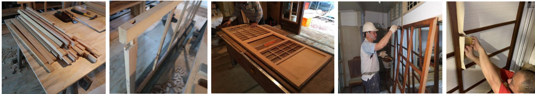
■ 新作門窗 – 木料開榫加工 --> 構件組裝 --> 塗刷護木漆 --> 貼附和紙/壁紙/玻璃
