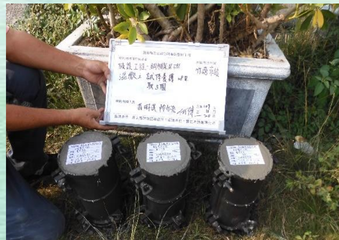
圓柱試體抗壓強度試驗取樣
