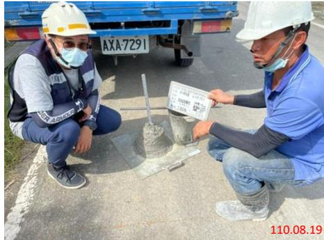
混凝土材料取樣
