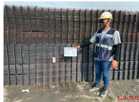
鋼線網材料取樣
