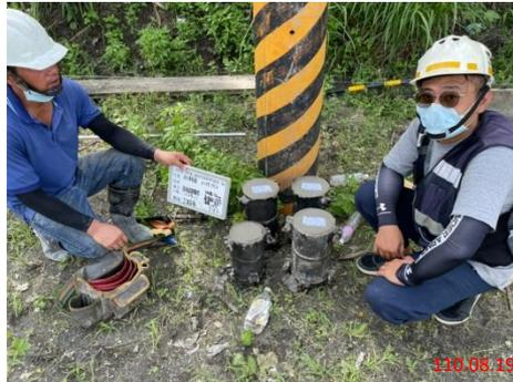
混凝土材料取樣
