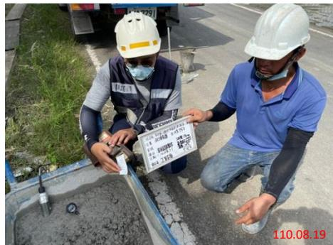
混凝土材料取樣
