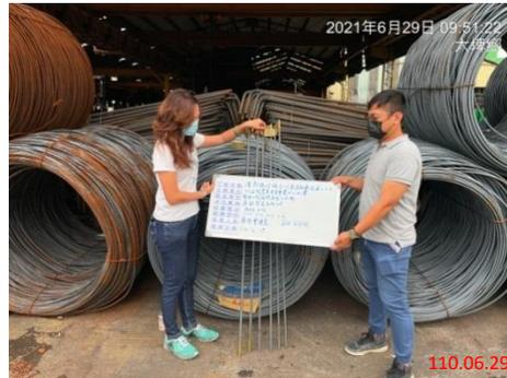
鋼筋材料取樣
