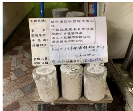
圓柱試體抗壓試驗
