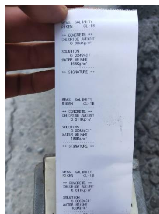
混凝土氯離子檢驗
