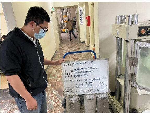
混凝土圓柱試體
