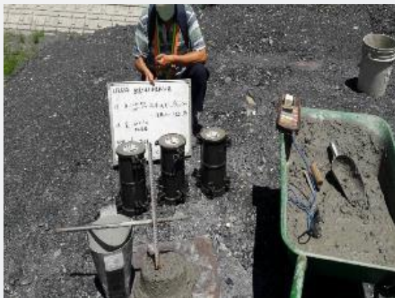
混凝土試體取樣
