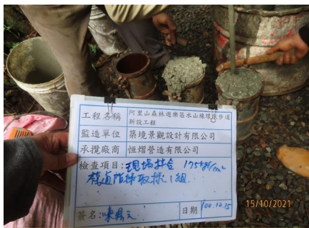
場拌混凝土取樣試驗
