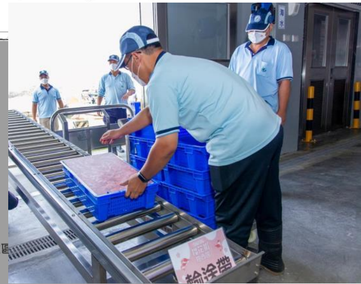
出入口設置雙層門/滾筒輸送機
