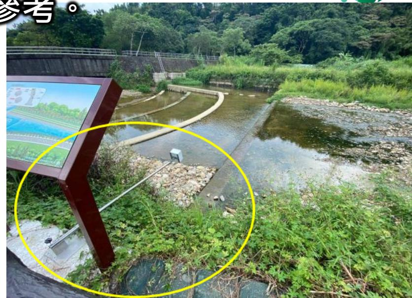
HOBO RG3雨量計 毫米波水位計
