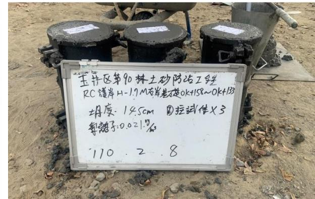
混凝土圓柱試體取樣
