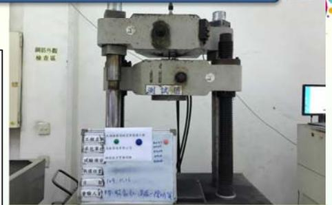
鋼筋抗拉伸試驗
