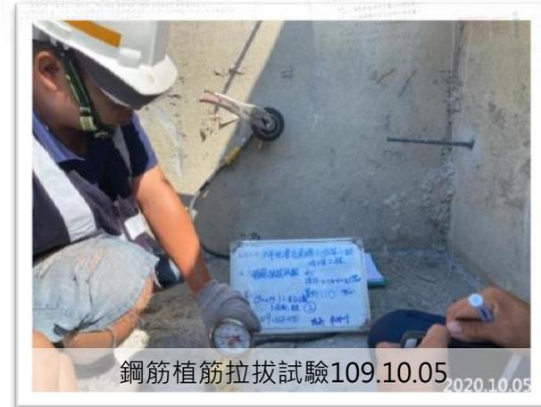
鋼筋植筋拉拔試驗109.10.05
