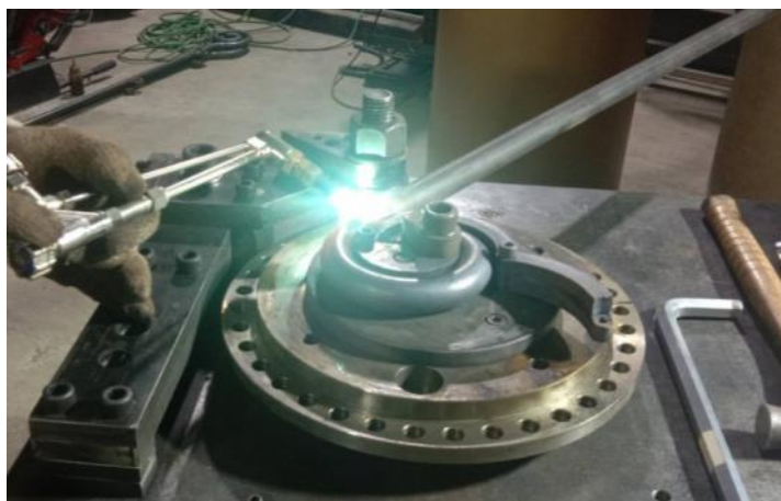
特製加工機具打造線型優美之蕨類鋼構製品
