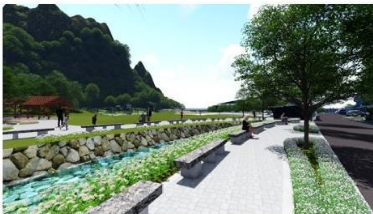
人車分道安全人行系統 水泥溝改造成多孔隙護岸溪流
