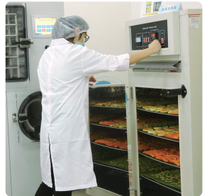
F. 熱風乾燥：可採變溫式結合除溼功能提高乾燥效率
