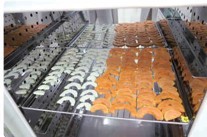
E. 擺盤：務必維持熱風流暢分布以達均勻乾燥目的
