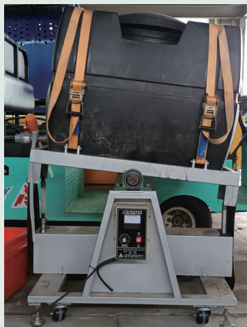
▲ 電動左右往復傾斜搖動裝置，可供 300 公升塑膠桶放置進行液肥發酵作業
