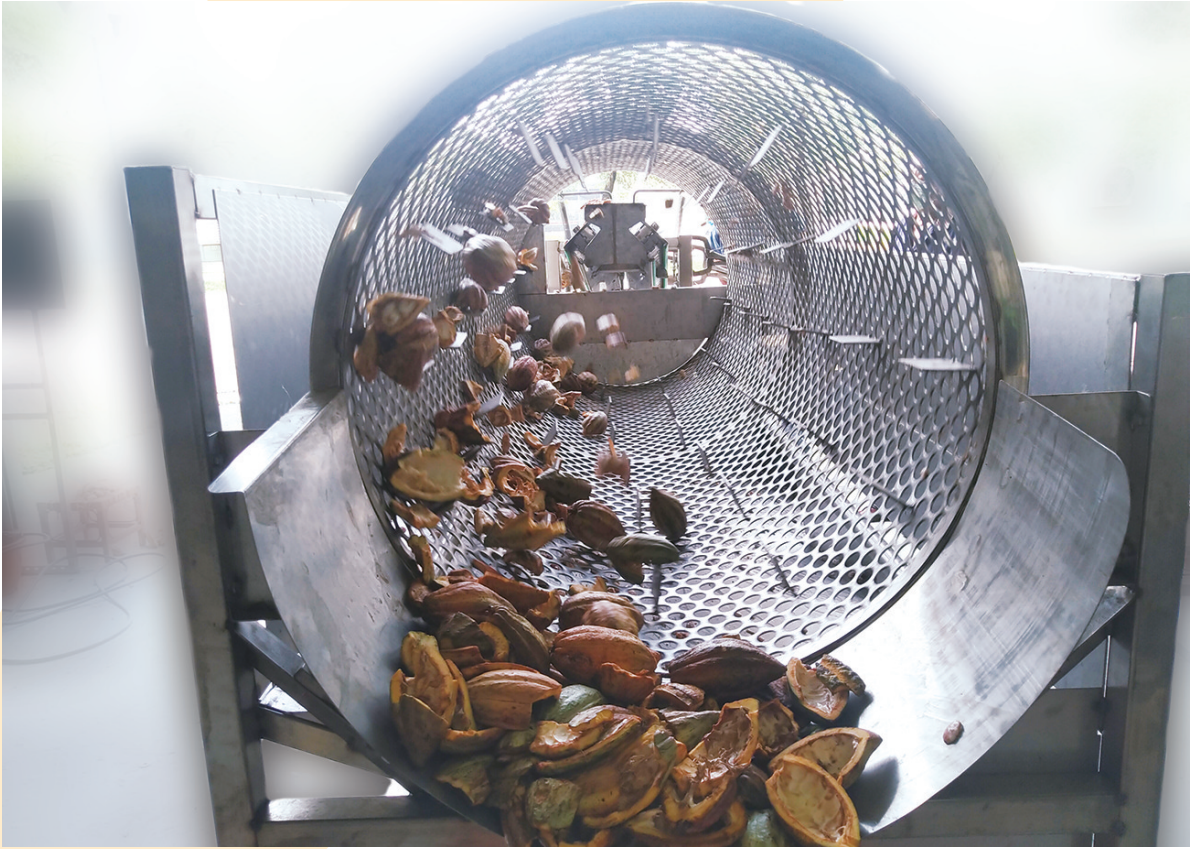
圖11.篩選滾筒排出可可殼情形
