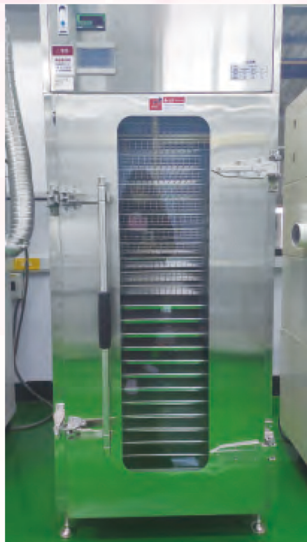
熱泵乾燥設備艙體密閉，熱空氣循環利用，節省能源耗損。
