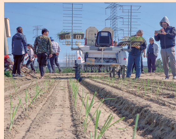
▲乘坐式全自動洋蔥移苗機作業情況，種植株距有9.3~12.3公分的微調功能
