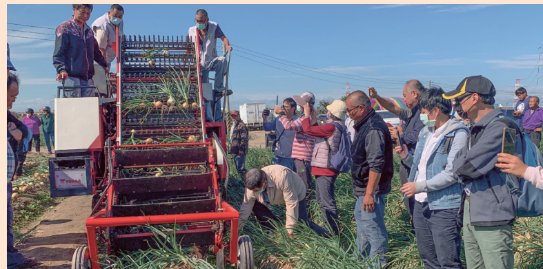
▲採收機可一次完成多項工序 - 挖掘、篩土、剪葉及收集洋蔥作業
