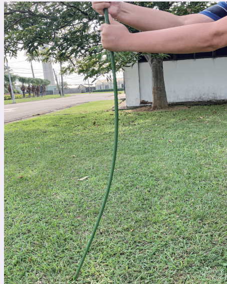
▲以直徑1公分鋼管園藝支架不能輕鬆插入土中，支架開始彎曲，則土壤硬度高於200 psi
