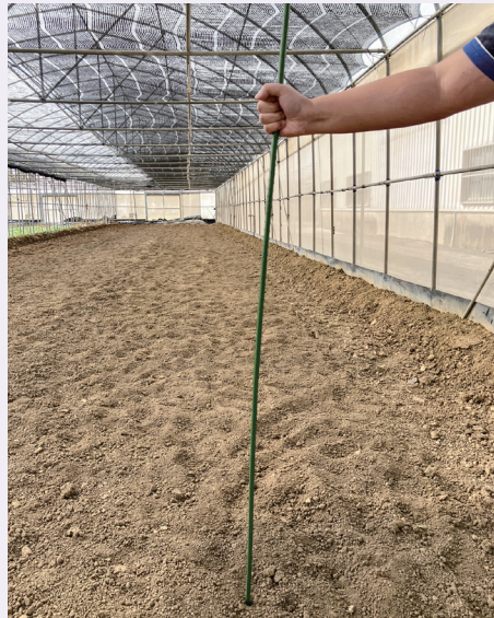
▲以直徑1公分鋼管園藝支架可輕鬆插入土中，則土壤硬度低於200 psi
