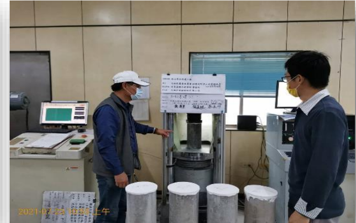
混凝土抗壓試驗
