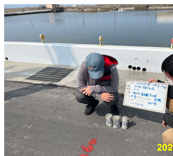
混凝土鑽心試體取樣
