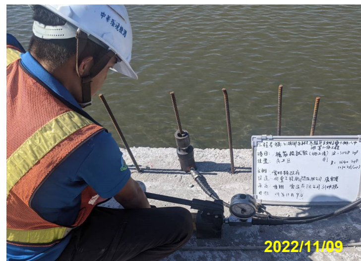
植筋拉拔試驗
