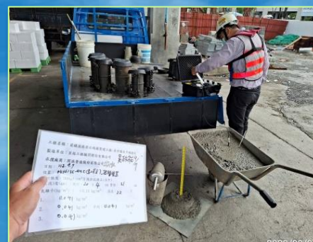
280kg/cm 2 -II型， 水中混凝土-氯離子試驗
