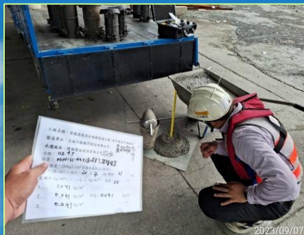
280kg/cm 2 -II型， 水中混凝土-坍度試驗
