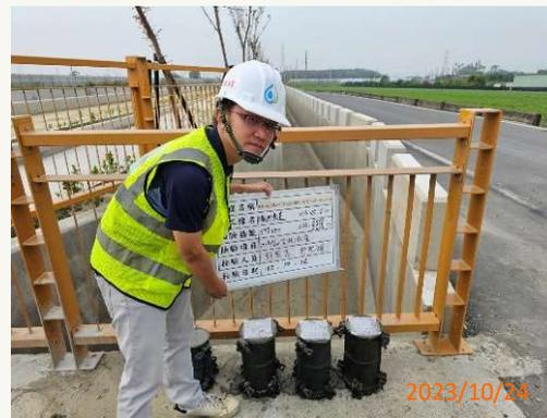
混凝土圓柱試體取樣
