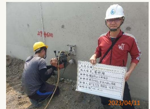
混凝土鑽心試體取樣
