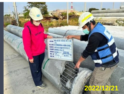
基樁破壞試驗
