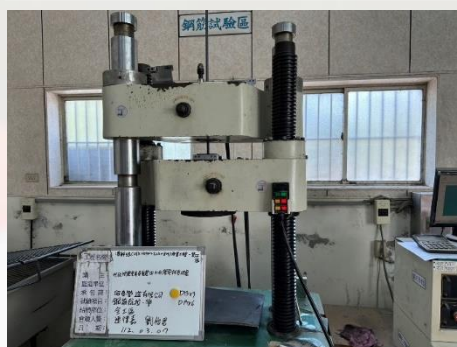
鋼筋拉拔試驗
