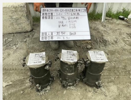
混凝土圓柱試體取樣
