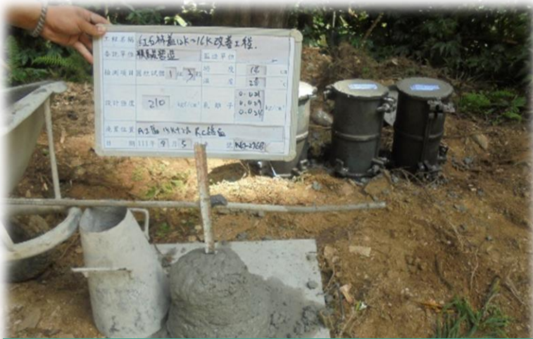
混凝土坍度及氯離子含量試驗
