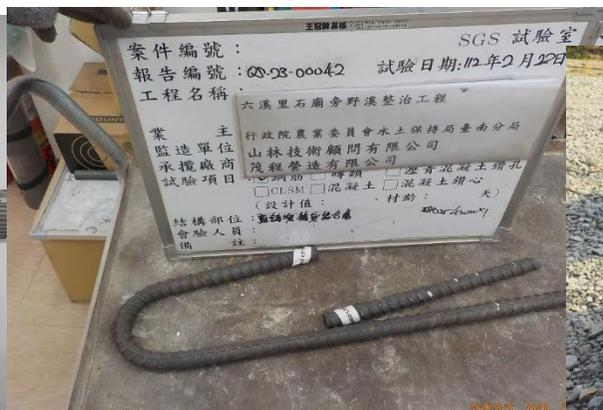
鋼筋抗彎試驗
