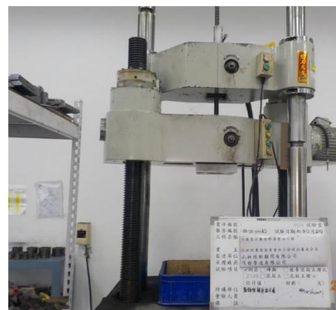
鋼筋拉力試驗
