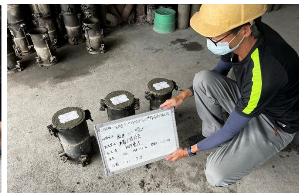
混凝土圓柱試體取樣
